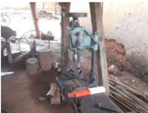
Photo n°9 : Perceuse en avant plan et soufflet mécanique en arrière-plan dans une forge à Bassila
