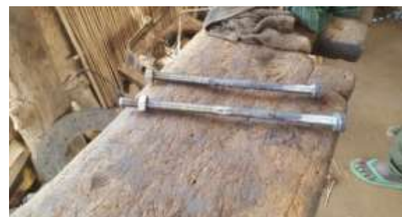
Photo n°6 : Boulons de ressort de camion poids lourd filés par le maître forgeron.
