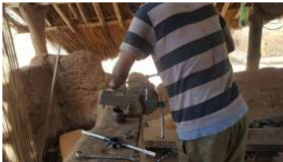
Photo n°4 : Limage d'un boulon de ressort de camion poids lourd par le maître forgeron.
