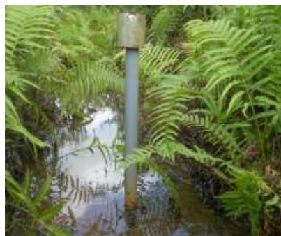
Photo 2 : Piézomètre installé dans le Bas – enregistrer les fluctuations de la nappe
