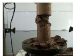
c) Rupture de l'éprouvette cylindrique
