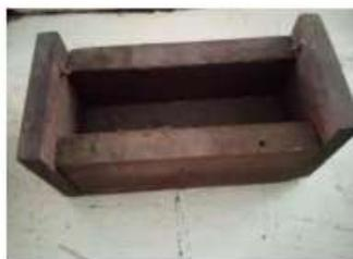
a) Moule d'éprouvette prismatique
